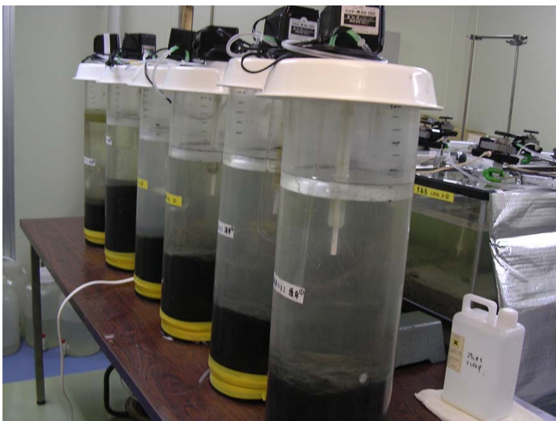
図 5-3-3 溶出速度試験の実施状況
