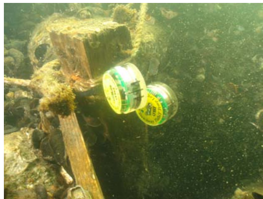
図 6-6-5(3) ボタン型水温計(ティドビット V2 米国オンセットコンピューター社製) 設置状況
