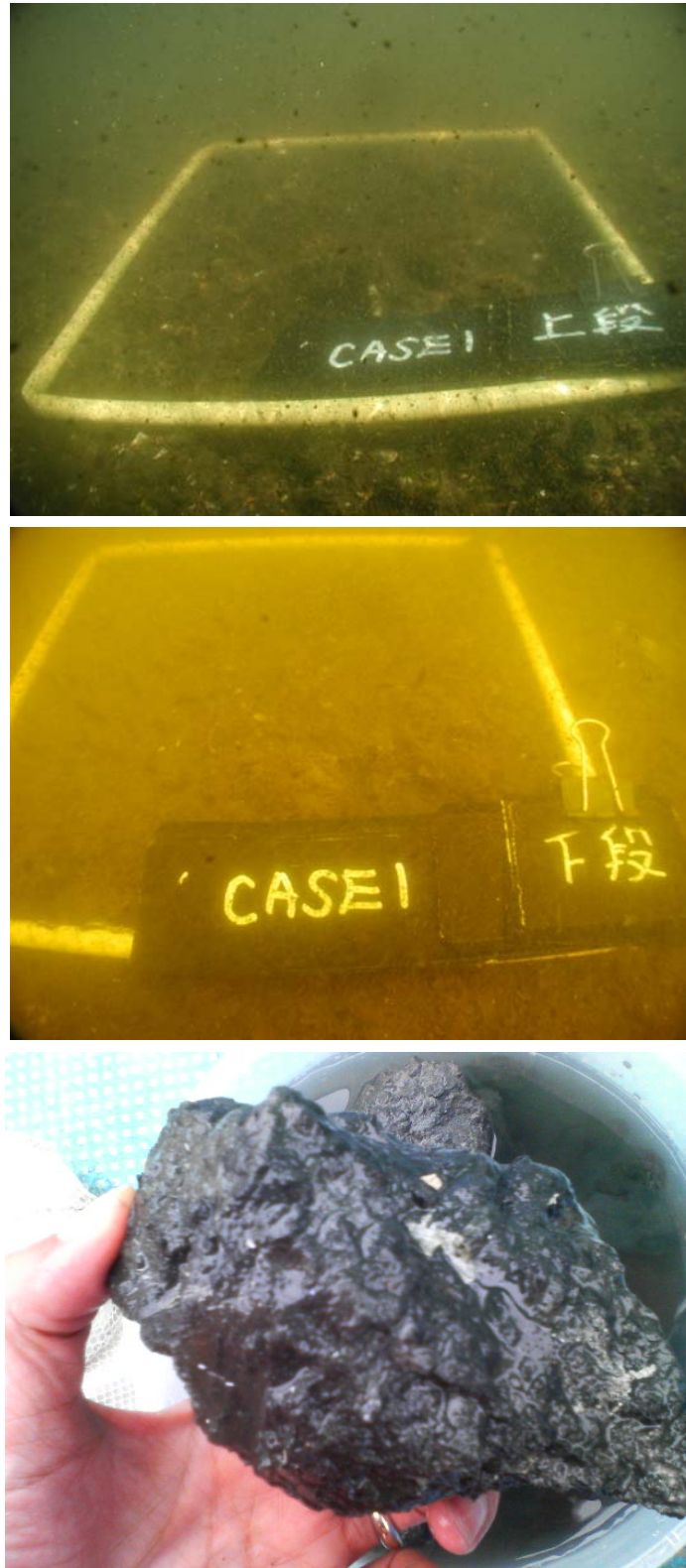
図 6-3-9 マウンドの状況とスラグ混合土（一軸圧縮試験用試料）
